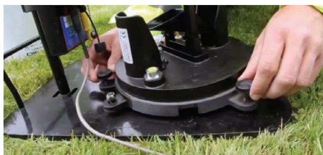
Ausrichten des Regenschreibers in unebenem Gelände
